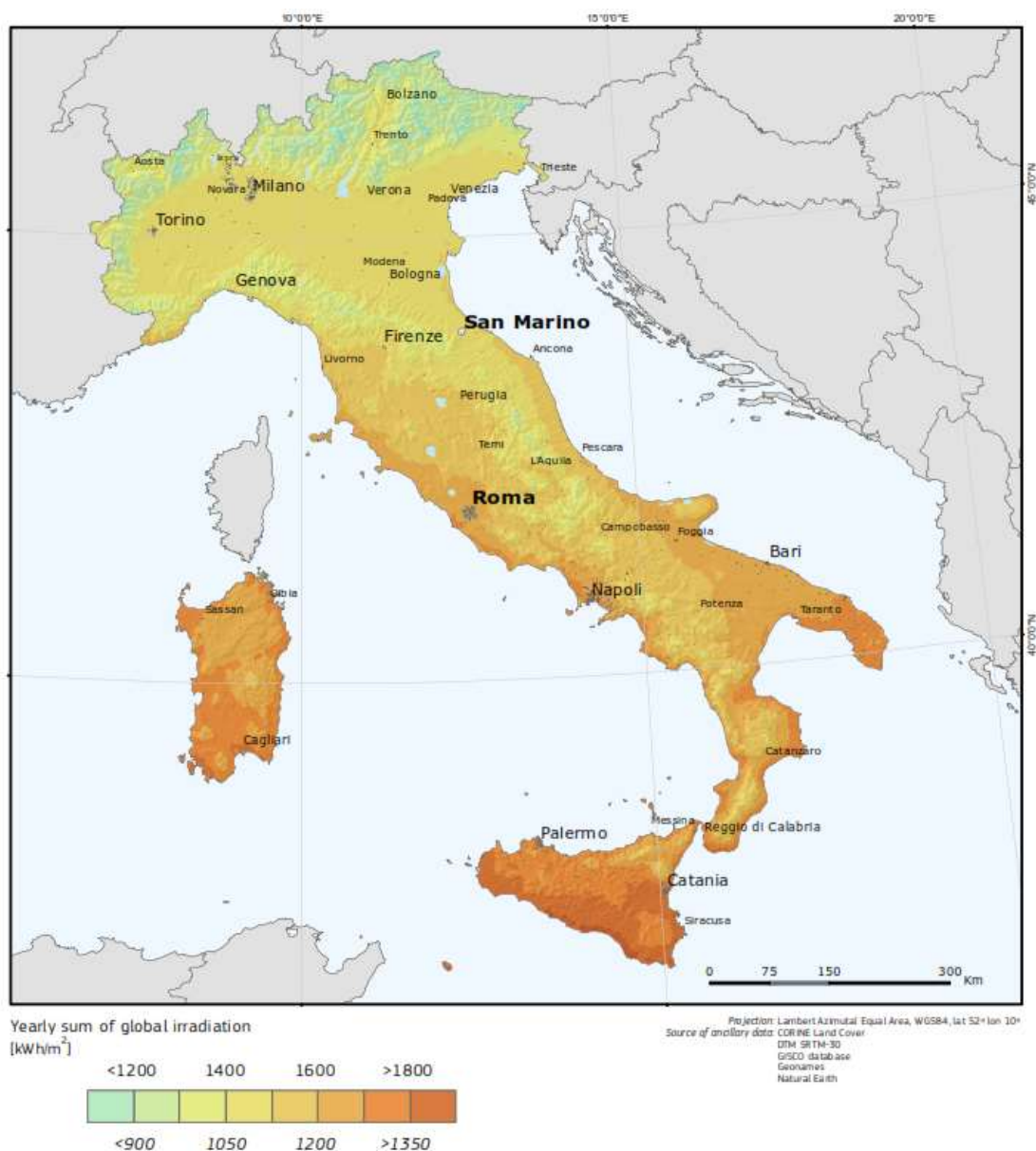
Figura 14. Irraggiamento globale e potenziale elettrico fotovoltaico
